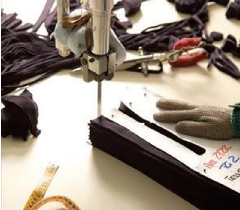
Band knife cutting machine // Image Courtesy: [www.oscalito.it](http://www.oscalito.it)
